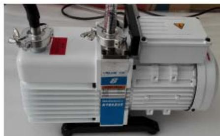
三、设备简介：低温等离子表面处理设备由真空腔体及高频等离子电源、抽真空系统、充气系统、自动控制系统等部分组成。工作基本原理是在真空状态下，等离子作用在控制和定性方法下能够电离气体，利用真空泵将工作室进行抽真空达到 30-40pa 的真空度，再在高频发生器作用下，将气体进行电离，形成等离子体（物质第四态），其显著的特点是高均匀性辉光放电，根据不同气体发出从蓝色到深紫色的彩色可见光，材料处理温度接近室温。这些高度活跃微粒子和处理的表面发生作用，得到了表面亲水性、拒水性、低摩擦、高度清洁、激活、蚀刻等各种表面改性。
