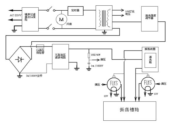
PDC-MG 型等离子清洗机原理框图
