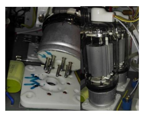
射频管的真确安装方法
